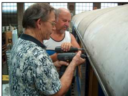
Aufsetzen des LSE-Kastens auf das revidierte Chassis des BVZ J 2407
